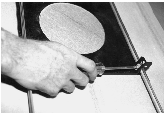
Afbeelding 9.4: Draai de bevestigingsschroef van het beugelsysteem vast
