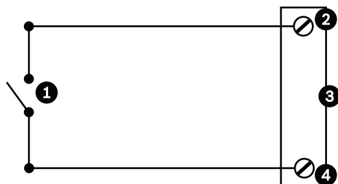
Afbeelding 11.4: N.O. - Normaal open niet-bewaakte aansluitingen
