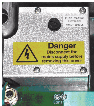
Afbeelding 4.3 Afscherming van de aansluitklem van de netspanningsingang in de PSU-behuizing
