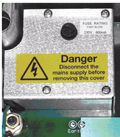
Afbeelding 3.3 Afscherming van de aansluitklem van de netspanningsingang in de PSU-behuizing
