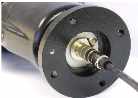
Afbeelding 5.9 Weergave van de aansluiting van de composietkabel op een MIC Serie 550 Camera
