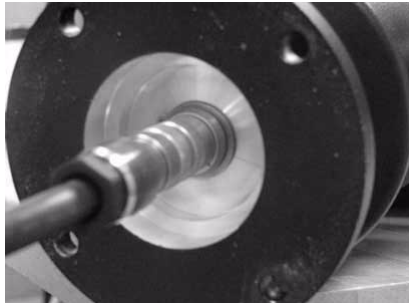
Afbeelding 3.7 Composietkabel aangesloten op MIC612 camera
